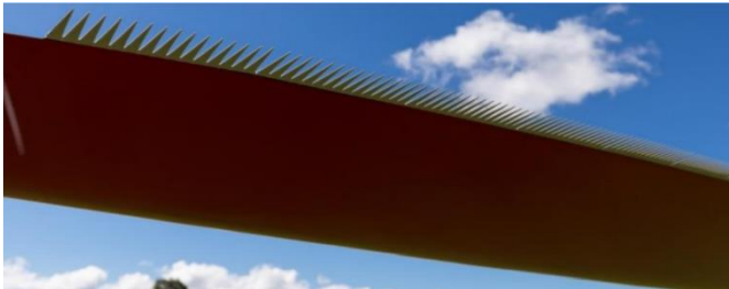
Figure 5 : Serrations sur une pale d'éolienne inspirées des chouettes
